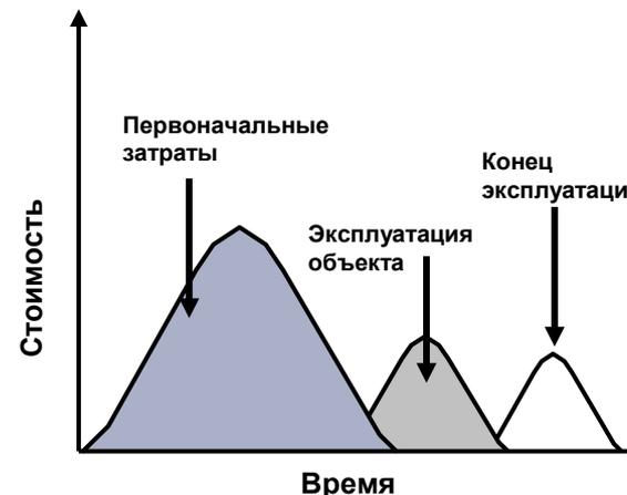
Рис.16. График распределения стоимости во времени для композитной арматуры
