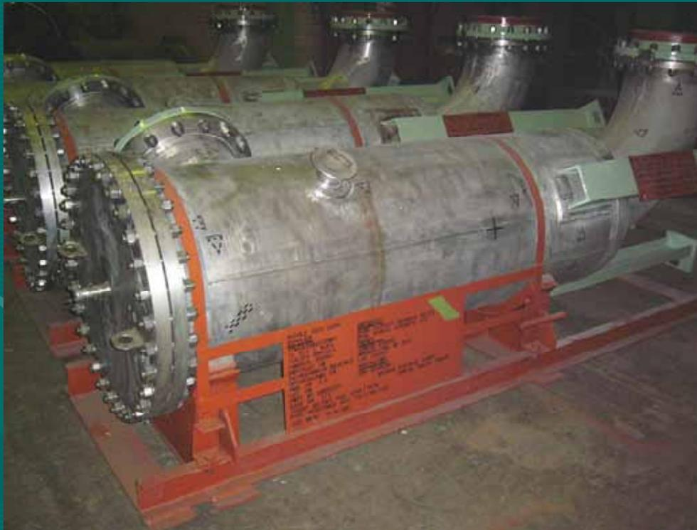
В зависимости от назначения корпуса фильтров-ловушек изготавливаются как из нержавеющей, так и углеродистой стали, как вертикального, так и горизонтального исполнения.
