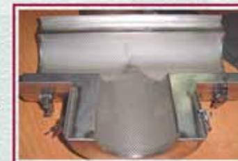
Две кассеты БСТИ одного из элементов трубопровода («тройник») в сборе.
