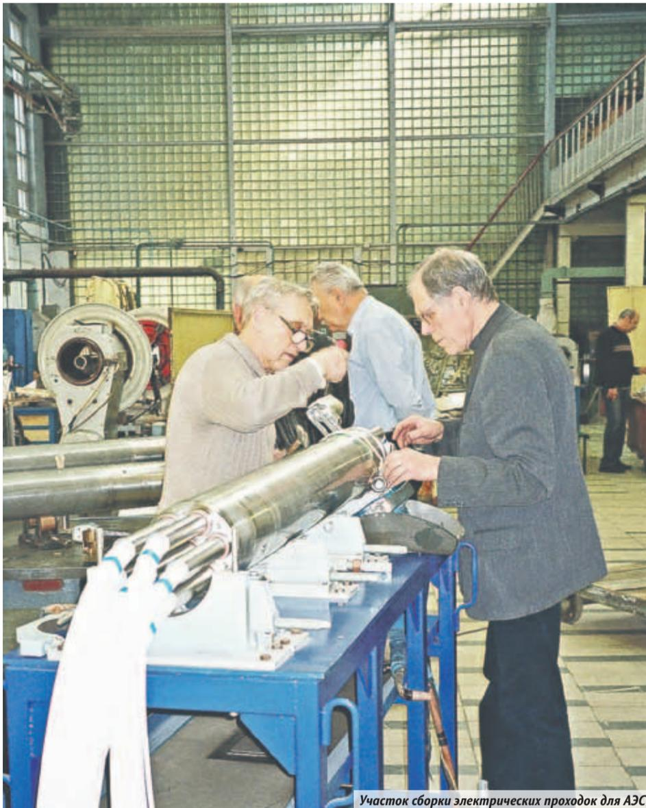
Участок сборки электрических проходок для АЭС
