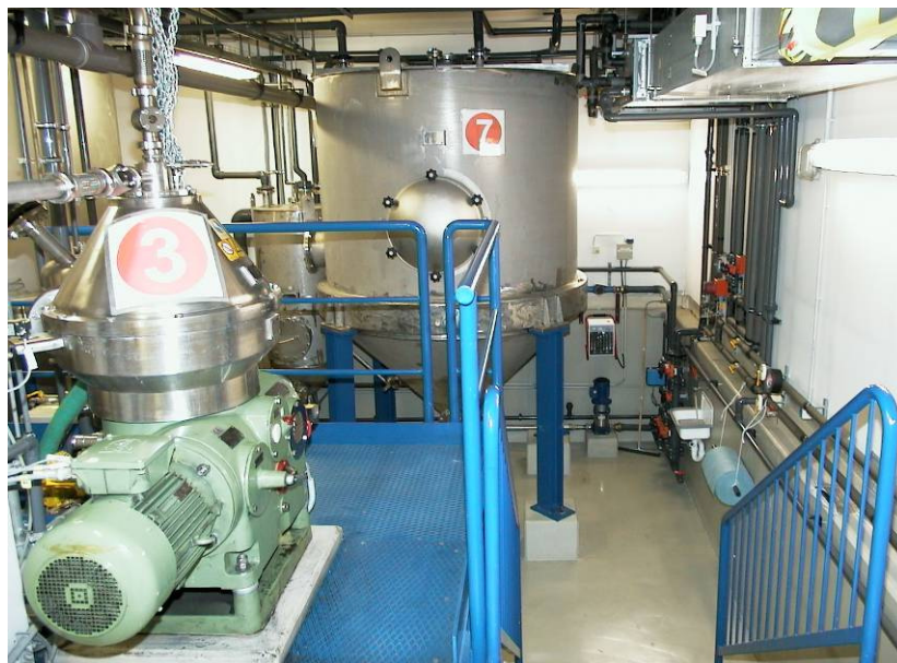
Компактная установка биологической очистки ЖРО на АЭС в Германии
