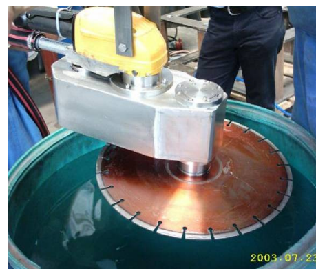
Подводное гидравлическое фрезерное устройство
