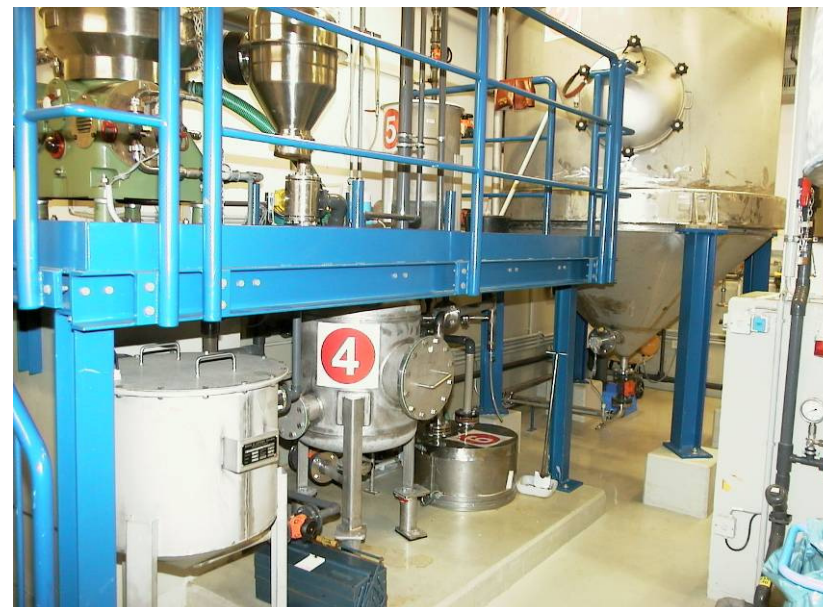
Компактная установка биологической очистки ЖРО на АЭС в Германии
