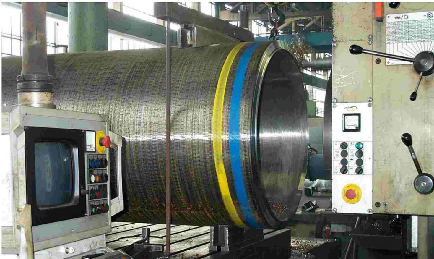
Программно-управляемая обработка кромки под сварку
