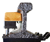
УСО Устройство счёта осей
