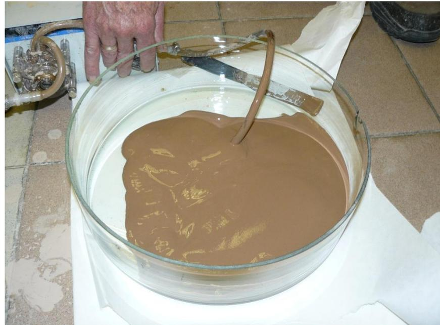
Концентрация твердого 55-60%.
