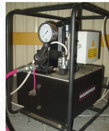
Насосная станция прессующего устройства
