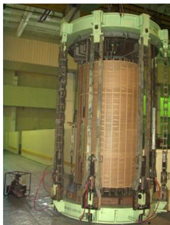
Сборка обмотки в прессующем устройстве
