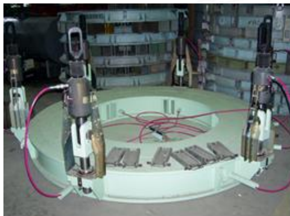
Нижняя плита прессующего устройства с установленными гидродомкратами
