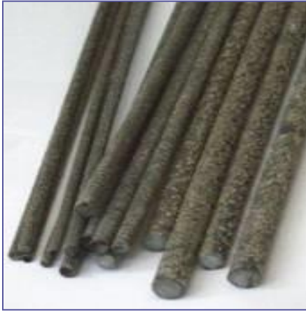
Рисунок 1. Композитные базальтопластиковые и углепластиковые стержни с адгезионным покрытием
