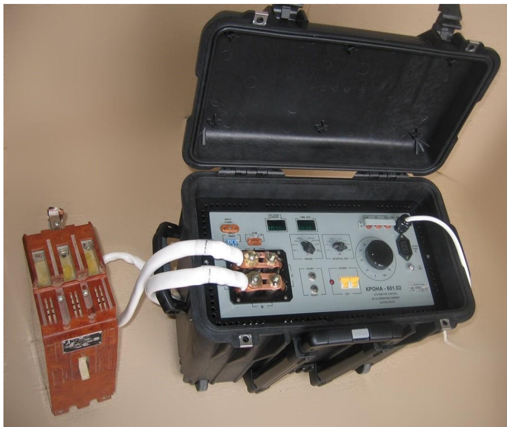
Рис.13 Устройство прогрузки автоматических выключателей «Крона-601.02»
