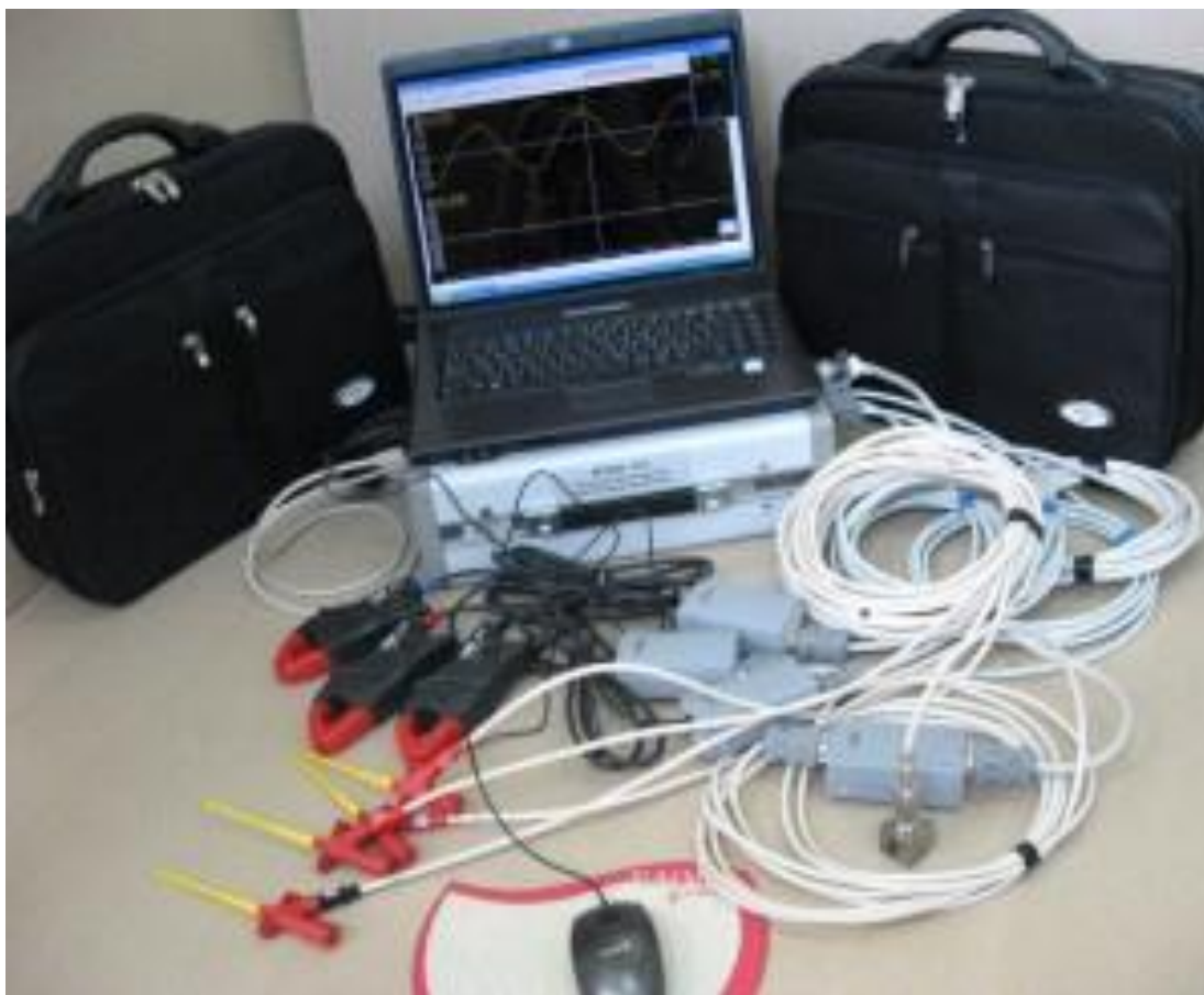
Рис.6 Стенд контроля параметров электроприводного оборудования и вращающихся механизмов «Крона–517»
