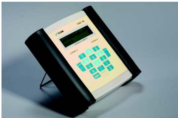
Рис.4 Портативный ультразвуковой расходомер жидкости FLUXUS® ADM F601 (F)
