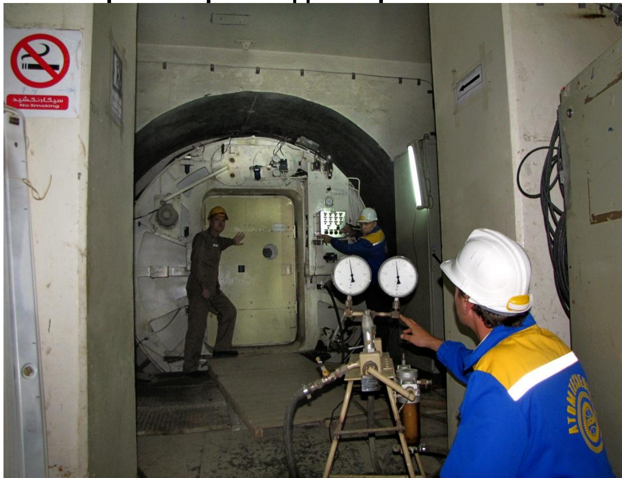
Рис.15 Испытания шлюза здания реактора АЭС «Бушер»
