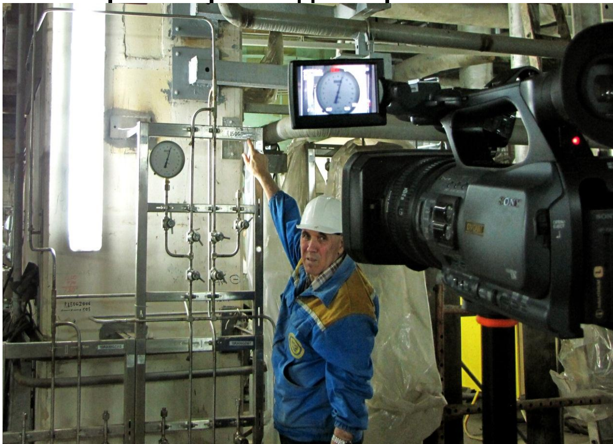
Рис.14 Гидроиспытания на прочность системы второго контура АЭС «Бушер»
