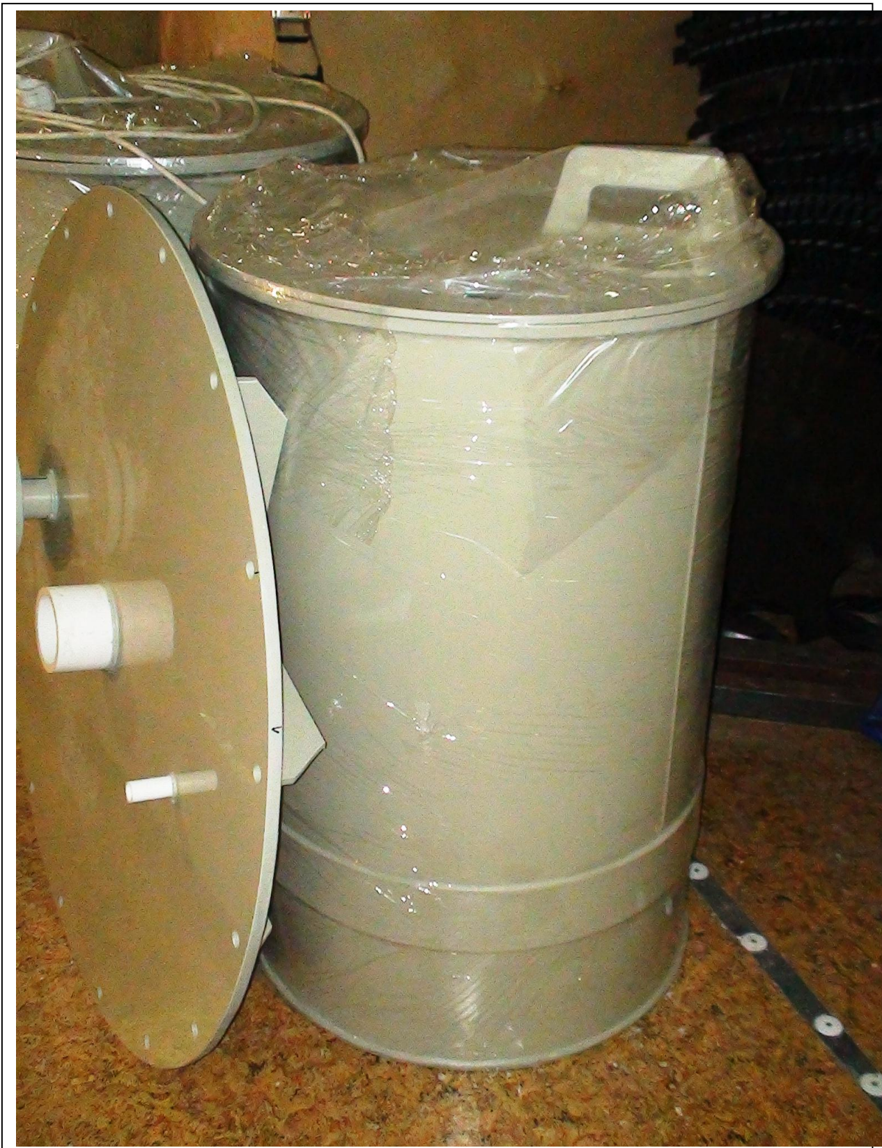
Ёмкость для приготовления раствора флокулянта
