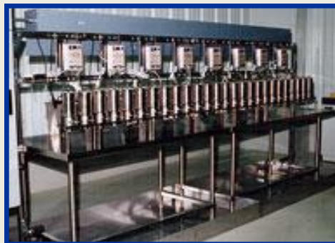
Установка ЭЦ33-28 для отработки технологии переработки радиоактивных отходов ("INEL", США)
