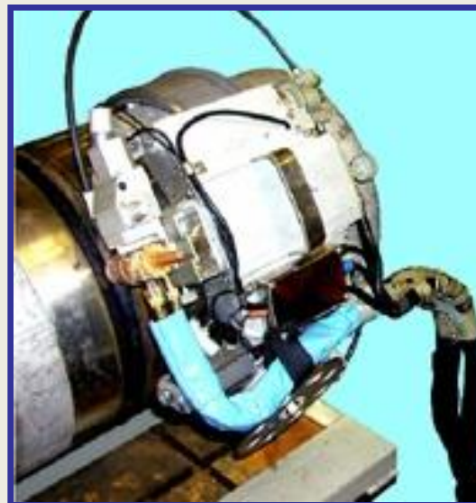
Установка автоматической орбитальной сварки СА-673
