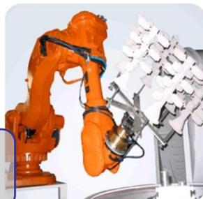
Роботизированная линия фирмы «Shell-o-Matic» (Канада)
