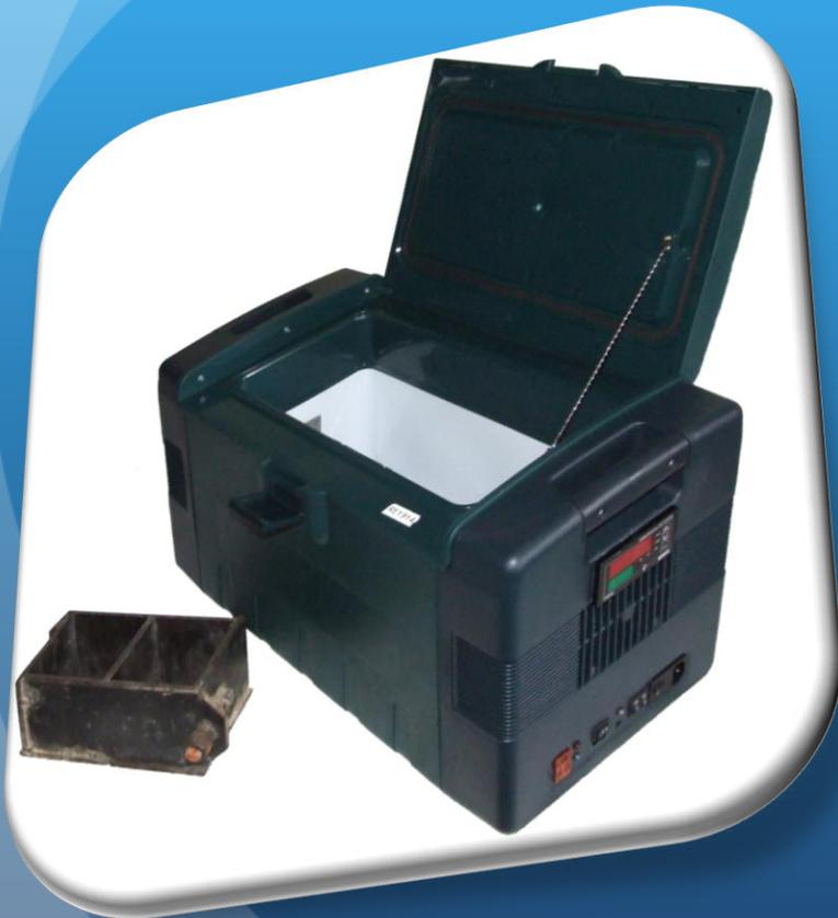
**Многоканальные комплексы для проведения ухода за бетоном в следящем режиме (по температуре выбранной точки конструкции), в том числе - следящая камера контрольных образцов.**
