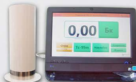
Радиометр РИС-А1-Э «Дозкалибратор»
